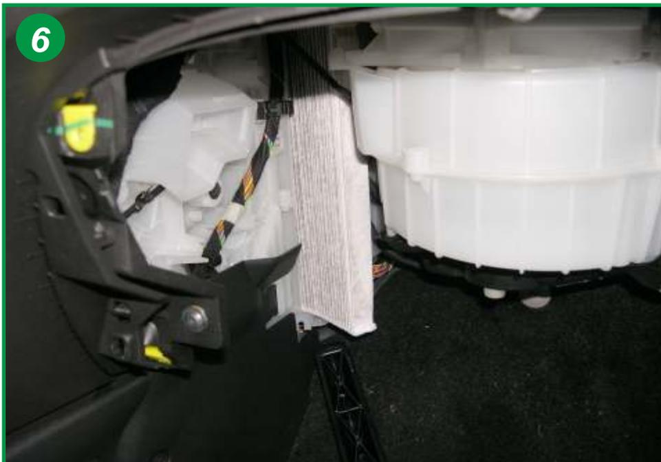
Extraire l'élément filtrant usagé en le déformant. Procéder à son remplacement. Le remontage s'effectue dans l'ordre inverse du démontage.
