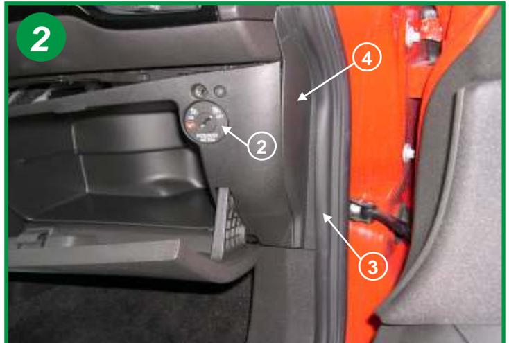
A l'aide de la clé de contact, basculer le commutateur de l'airbag sur OFF (2).
