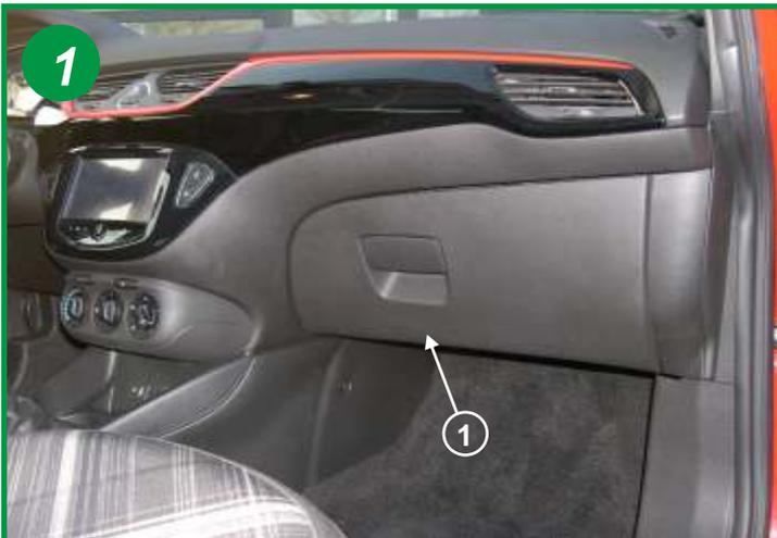
Le filtre d'habitacle est situé à l'intérieur du véhicule, coté passager derrière la boîte à gants, coté console centrale (1).
