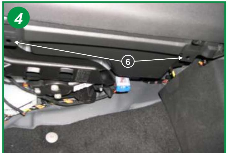
Dévisser les 2 vis Torx (T20) (6) et extraire le bloc boîte à gants en prenant soin de débrancher la connectique de l'airbag.
