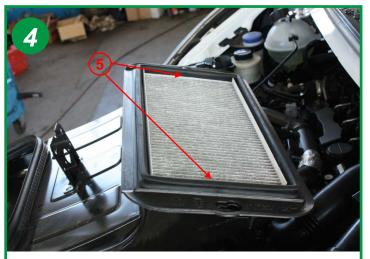
Retourner le bloc complet pour accéder au filtre. Procéder au changement de l'élément en imbriquant les 2 premiers plis à chaque extrémité dans les gorges prévues à cet effet (5). Le remontage s'effectue dans l'ordre inverse du démontage.
