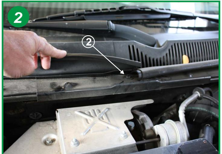
Dévisser la vis Torx T35 (2) et retirer le support métallique .
