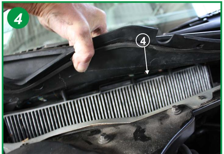
Soulever la demi-grille d'aération et la maintenir soulevé (il est possible de placer une cale pour le maintenir ouvert) puis actionner le loquet (4) afin de dégager l'élément filtrant. Remonter le filtre neuf dans son cadre et rabaisser le loquet. Le remontage s'effectue dans l'ordre inverse du démontage.
