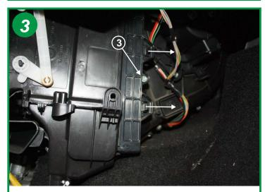
Dévisser la vis hexagonale de 5,5 mm (3) et faire coulisser le couvercle dans le sens de la flèche pour le retirer.
