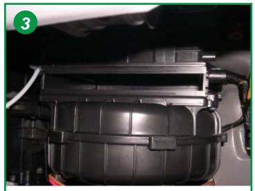
Retirer le filtre usagé et procéder au remplacement.
