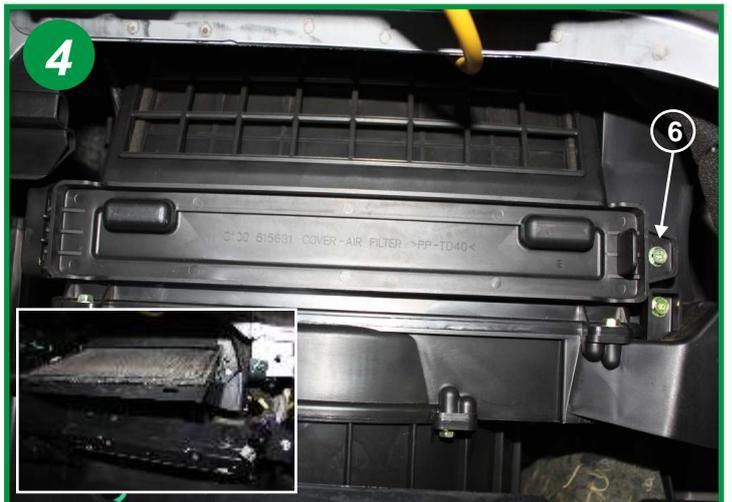
Dévisser la vis cruciforme (6) et retirer le couvercle du boîtier filtrant. Extraire l'élément filtrant usagé et procéder à son remplacement. Le remontage s'effectue dans l'ordre inverse du démontage.
