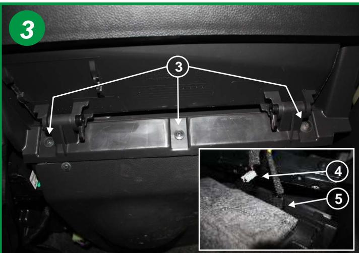
Dévisser ensuite les 3 vis cruciformes sous la boîte à gants (3) retirer celle-ci totalement en prenant soin de débrancher la prise de connexion du plafonnier (4) et la prise de réfrigération (5)(voir encadré).
