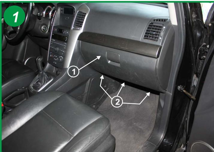
Le filtre d'habitacle est situé à l'intérieur du véhicule côté passager derrière la boîte à gants (1). Dévisser les 3 vis cruciformes sous la boîte à gants (2).
