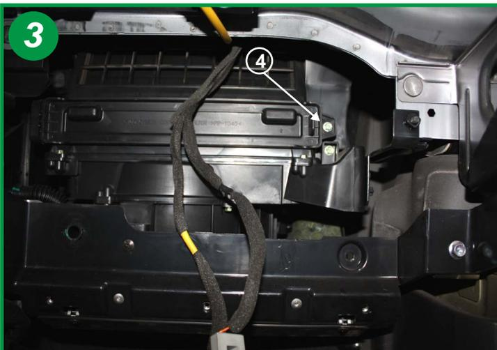
Le boîtier filtrant est alors devant vous, dévisser la vis cruciforme (4) pour retirer le couvercle. Ce couvercle est articulé sur sa partie gauche.
