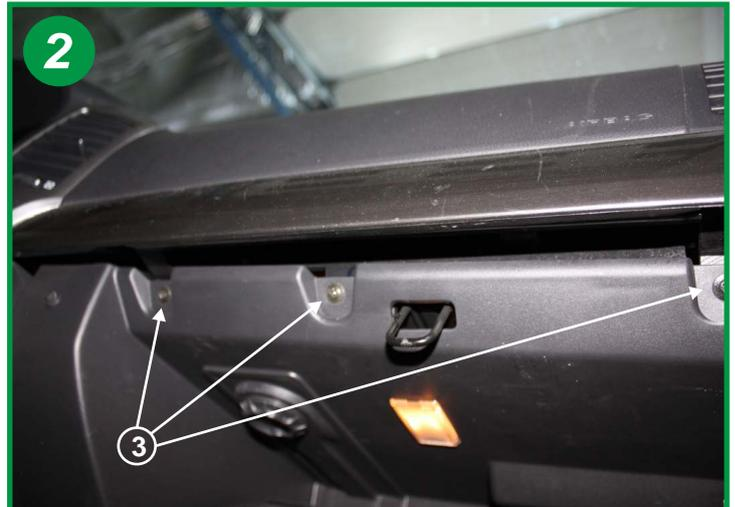
Ouvrir ensuite la boîte à gants et dévisser les 3 vis cruciformes situées dans sa partie supérieure (3). Retirer dans sa totalité la boîte à gants et débrancher les 2 connectiques (plafonnier et réfrigération de la boîte)
