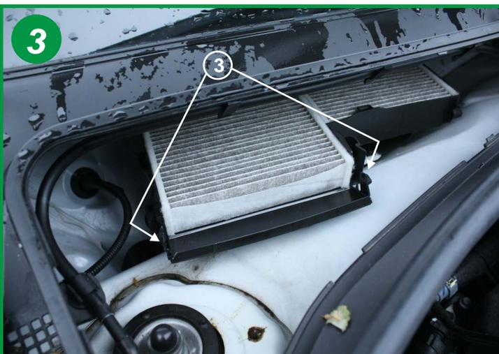
Ouvrir le boîtier filtrant en rabattant la face avant. Actionner les 2 fermoirs (3).
