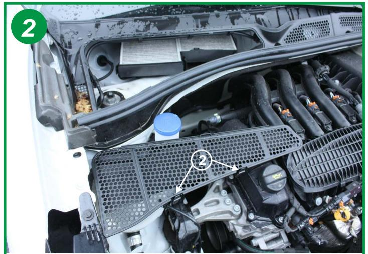
Actionner les 2 pattes fermoirs (2) sur la petite grille de ventilation et l'extraire totalement.
