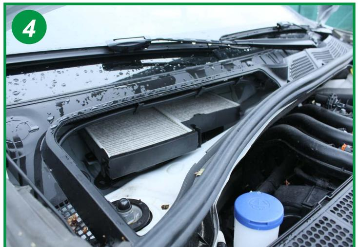
Replacer 2 éléments filtrants neufs et refermer la face avant (jusqu'au clic !). Remettre à présent la grille de ventilation.
