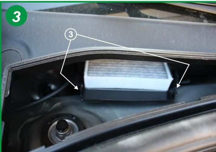
Ouvrir le boîtier filtrant en faisant basculer la trappe d'entrée grâce aux 2 clips situés aux extrémités (3).
