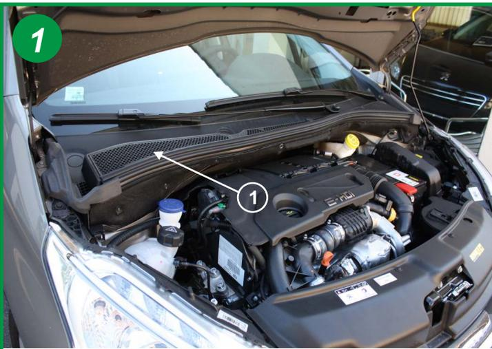
Les filtres d'habitacle sont situés sous le capot moteur, côté passager devant la baie de pare-brise (1).
