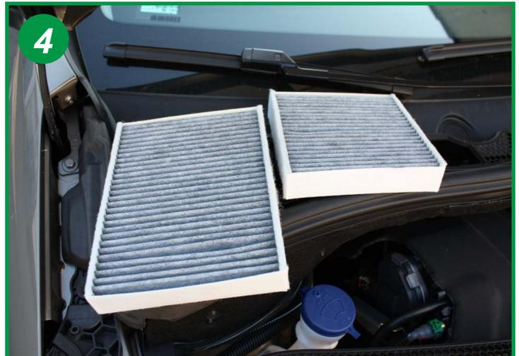
Extraire les 2 éléments filtrants usagés et les remplacer le remontage s'effectue dans l'ordre inverse du démontage.
