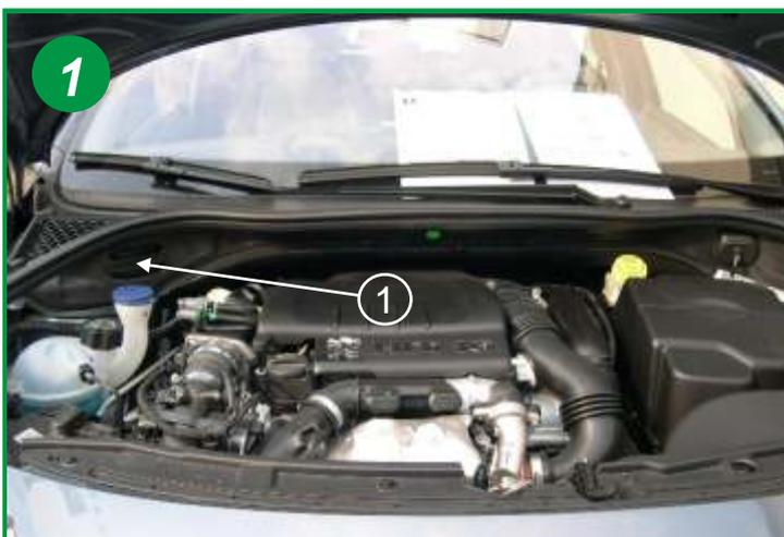
Le boîtier filtrant est situé sous le capot moteur, côté passager (voir flèche 1)
