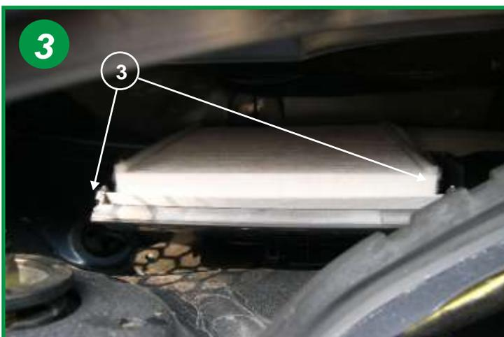
Basculer tout d'abord le loquet de fermeture vers le bas (flèche 3). Retirer les éléments filtrants usagés, d'abord le plus grand, puis le plus petit au fond à droite
