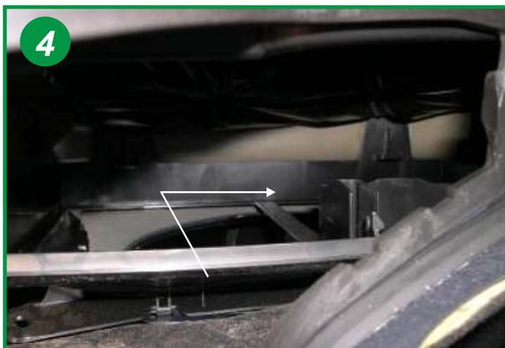
Replacer 2 filtres neufs, d'abord le plus petit puis le plus grand dans le sens de la flèche. Refermer le loquet puis réajuster la trappe de fermeture du boîtier.
