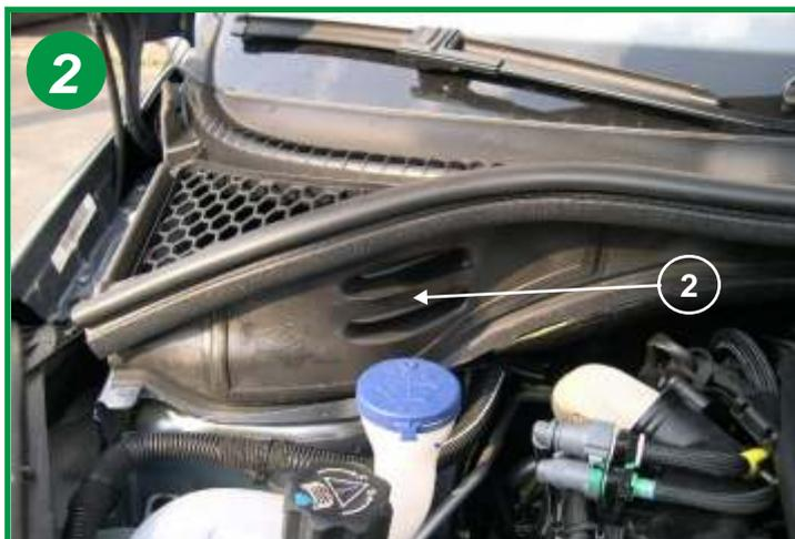
Les 2 filtres sont logés l'un à côté de l'autre derrière la trappe ci-dessus (voir flèche 2). Ouvrir la trappe.
