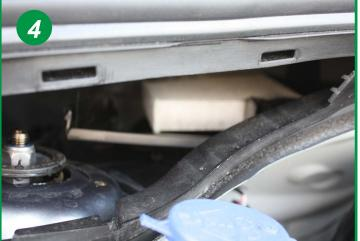
Puis retirer le second filtre au fond du boitier, ils sont placés l'un à coté de l'autre, le deuxième étant plus petit. Le remontage s'effectue dans l'ordre inverse du démontage.
