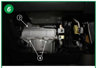
Ecarter la connectique (7) et ouvrir le boitier filtrant en tirant sur les 2 fermoirs (8) du couvercle.
