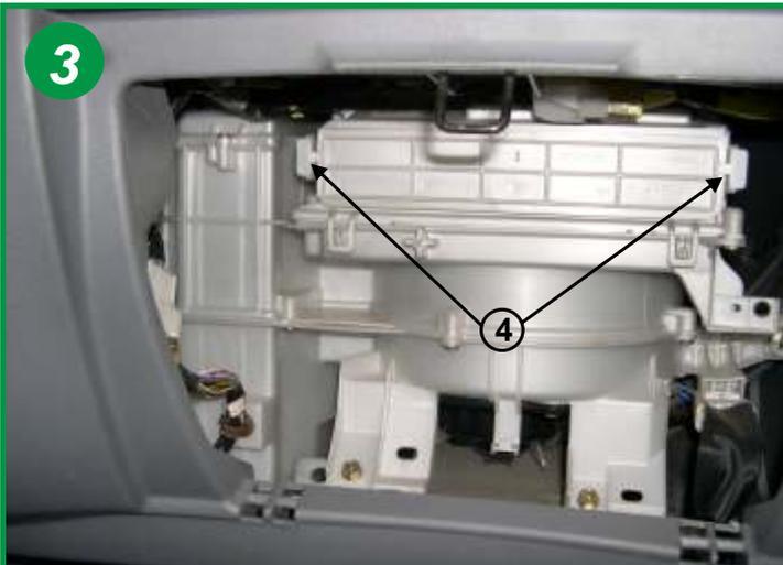
Faire pression sur les deux pattes de fixation (flèche 4) et dégager le tiroir contenant l'élément filtrant.
