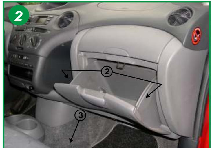
Presser les flans du caisson de la boîte à gants afin de dégager de ces arrêtoirs (flèche 2), puis la basculer et la retirer (flèche 3).
