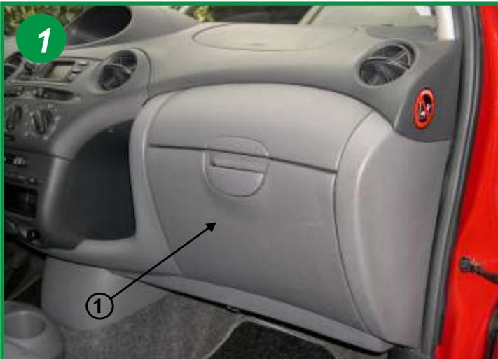
L'élément filtrant est situé derrière la boîte à gants côté passager (voir flèche 1).
