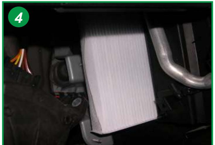
Extraire l'élément filtrant usagé et procéder à son remplacement. Le remontage s'effectue dans l'ordre inverse du démontage.
