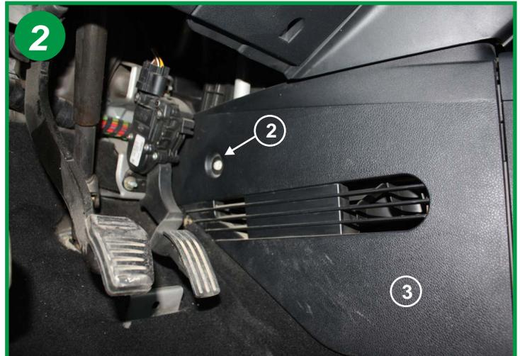
Retirer le clips plastique (2) et dégrafer la joue de la console centrale (3). Retirer ce carter dans sa totalité.
