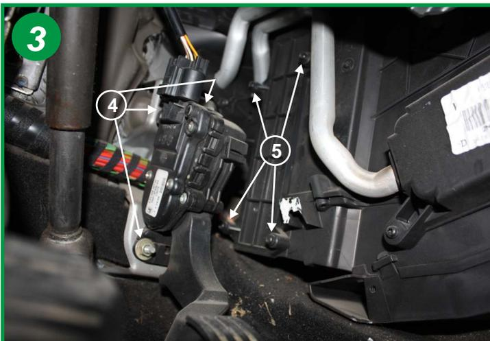
Dévisser les 3 écrous de 10 de fixation de la pédale d'accélérateur et la mettre de coté (4). Dévisser ensuite les 4 vis cruciformes (5) du couvercle du boîtier filtrant et retirer ce couvercle.
