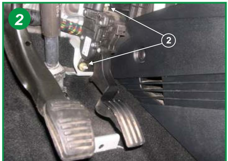
Dévisser les 3 écrous de fixation de la pédale d'accélérateur (voir flèche 2) et la déplacer sur le coté.
