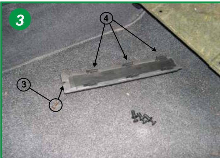
Dévisser le couvercle du boîtier de l'élément filtrant fixé par une vis six pans (voir flèche 3) et faire coulisser le couvercle d'environ 20 mm vers la gauche afin de désolidariser les ergots (voir flèche 4)
