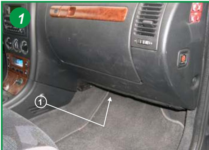
L'élément filtrant est situé sous la boîte à gants dans l'habitacle du véhicule coté passager (voir flèche 1).
