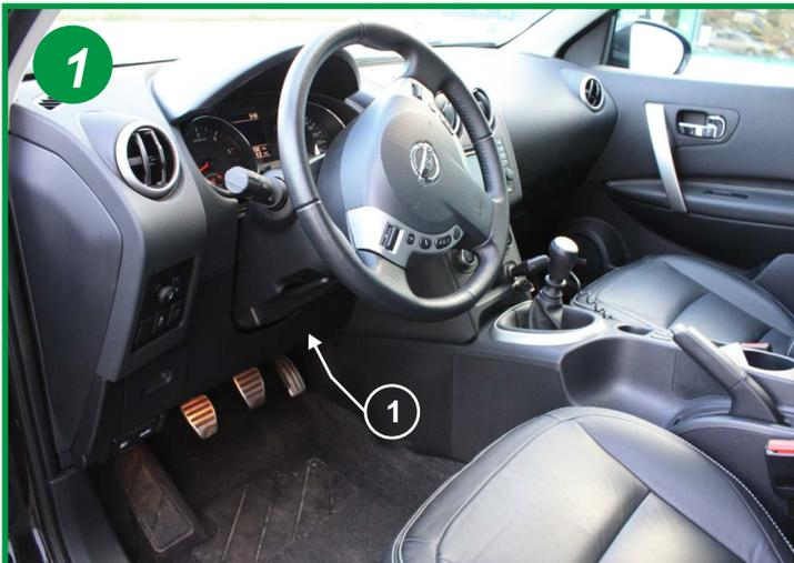
Le filtre d'habitacle est situé à l'intérieur du véhicule, côté conducteur derrière la console centrale (1).
