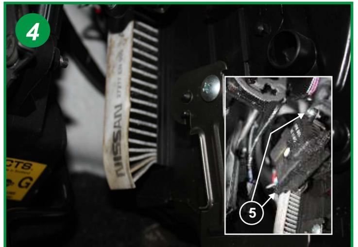
Dévisser les 2 vis de 8 mm (5) afin de dégager le boîtier électronique (voir encadré) sans le débrancher et extraire le filtre usagé. Le remontage s'effectue dans l'ordre inverse du démontage.
