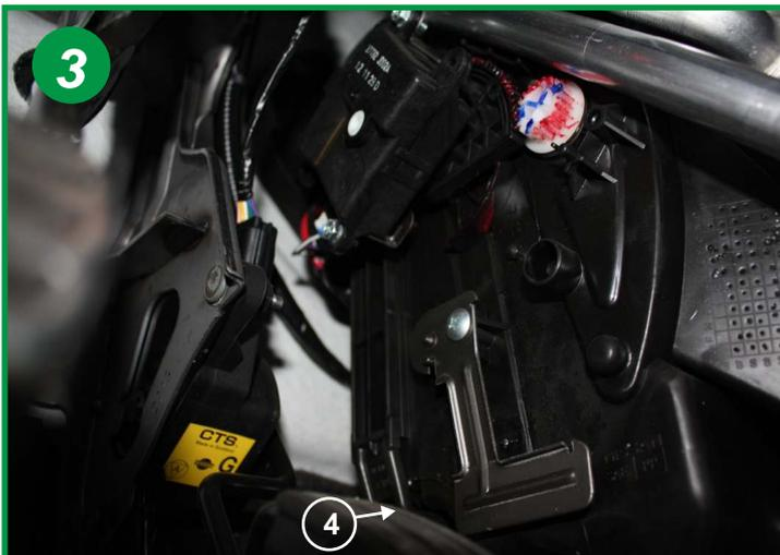
Dégager par le dessous le couvercle du boîtier filtrant (4) et le retirer totalement (il est nécessaire d'appuyer sur la pédale d'accélérateur pour dégager ce couvercle). Attention, il y a une encoche dans sa partie supérieure.
