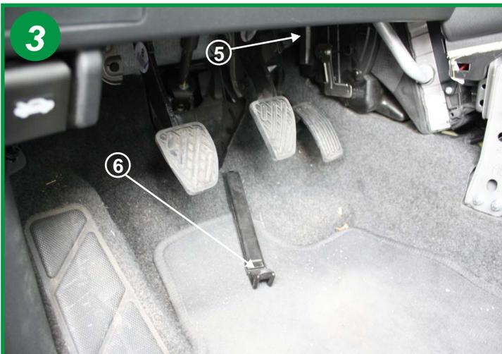
Le boîtier filtrant est situé au repère (5), faire appui sur la base du couvercle pour le retirer (6)
