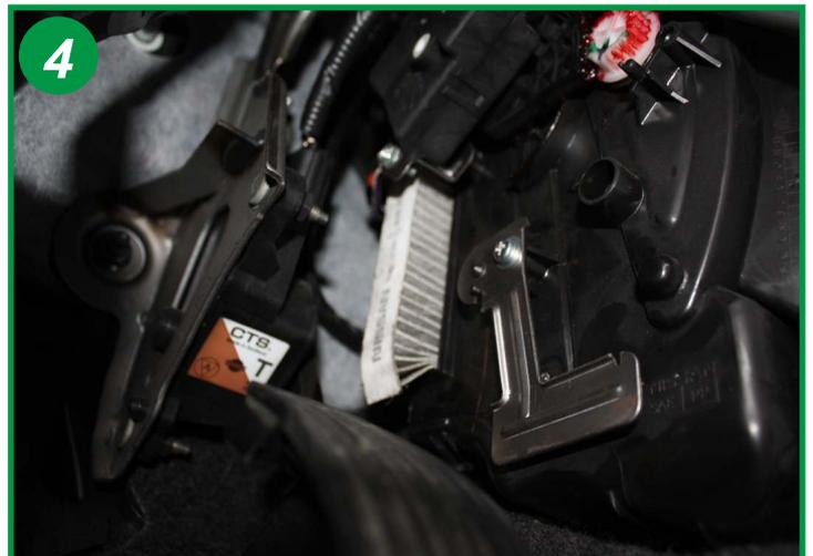
Extraire l'élément filtrant usagé, il est nécessaire de le déformer pour le retirer, l'entrée du boîtier étant plus petite que la largeur du filtre.
