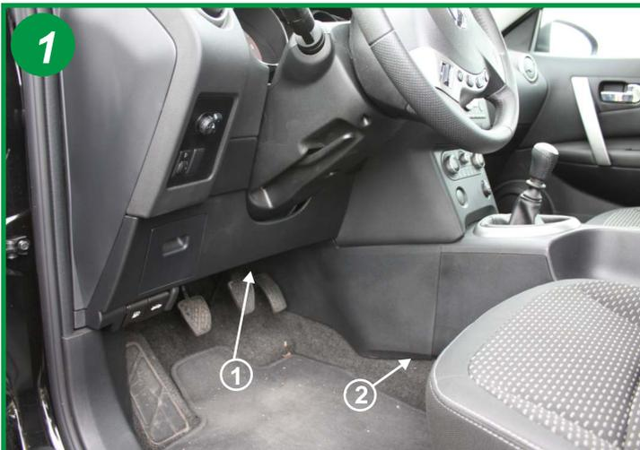
Le filtre d'habitacle est situé à l'intérieur du véhicule, coté conducteur, à droite de la colonne de direction, coté console centrale (1). Exercer une pression en bas de la console (2) afin de dégager le carter plastique.
