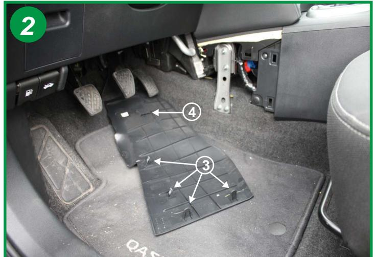
Retirer le carter dans sa totalité, il est fixé par 4 agrafes (3) et un guide de positionnement (4).
