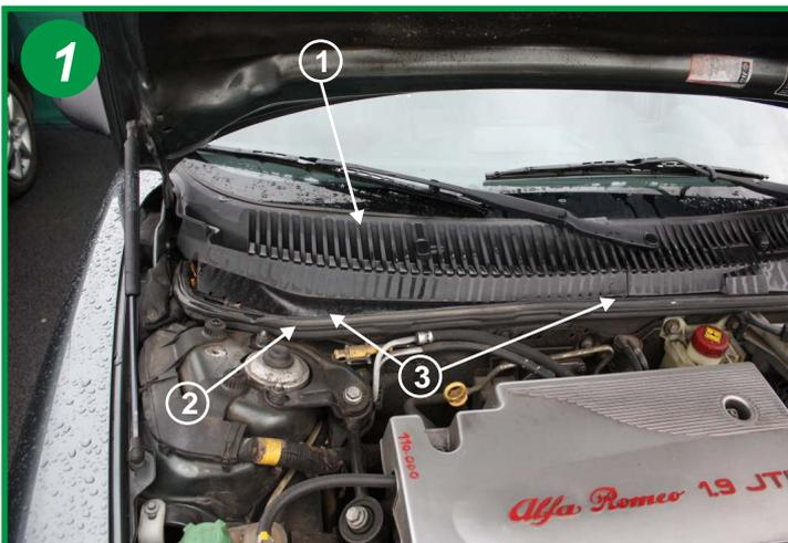
Le filtre d'habitacle est situé sous le capot moteur sous la baie de pare-brise coté passager (1). Retirer le joint d'étanchéité moteur sur la moitié (2) puis les 2 vis cruciformes (3).
