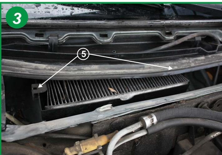
Basculer les 2 loquets plastiques de part et d'autre du boîtier filtrant (5).
