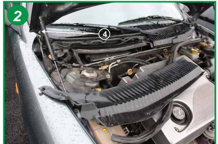
Dévisser la vis cruciforme (4) situé près de l'articulation du capot gauche, retirer auparavant le cache-vis. Retirer le carter plastique dans sa totalité. Attention au joint d'étanchéité entre le pare-brise et ce carter (il risque de rester collé sur le verre).
