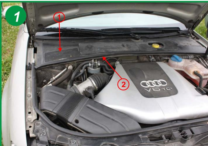
Le filtre habitacle est situé sous le capot moteur, côté passager sous la baie de pare-brise (1).
