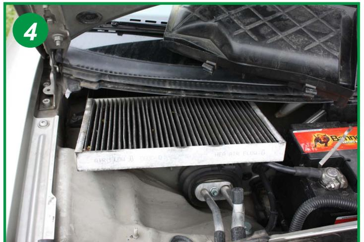
Remplacer le par un filtre neuf.
