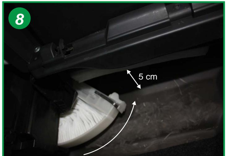
Extraire le filtre usagé en le déformant, le faire passer derrière le bloc boîte à gants écarté. Procéder à son remplacement. Le remontage s'effectue dans l'ordre inverse du démontage.
