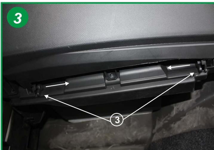
Retirer les 2 loquets de maintien de la porte de boîte dans le sens des flèches (3).
