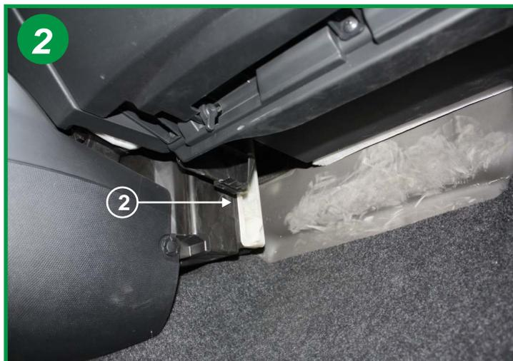
Voici le boîtier du filtre (2) il est nécessaire de démonter une partie de la boîte à gants pour remplacer l'élément filtrant.
