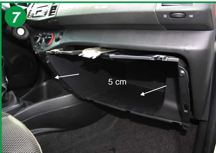
Sortir d'environ 5 cm le bloc boîte à gants (voir flèches) il n'est pas nécessaire de l'extraire totalement.
