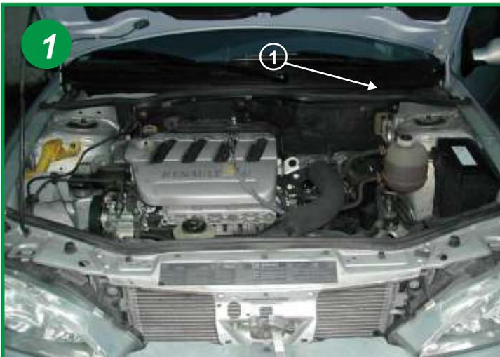
L'élément filtrant est situé sous le capot moteur devant la baie du pare brise côté conducteur (repère 1). Ouvrir le capot moteur et localiser le boîtier du filtre à air d'habitacle.
