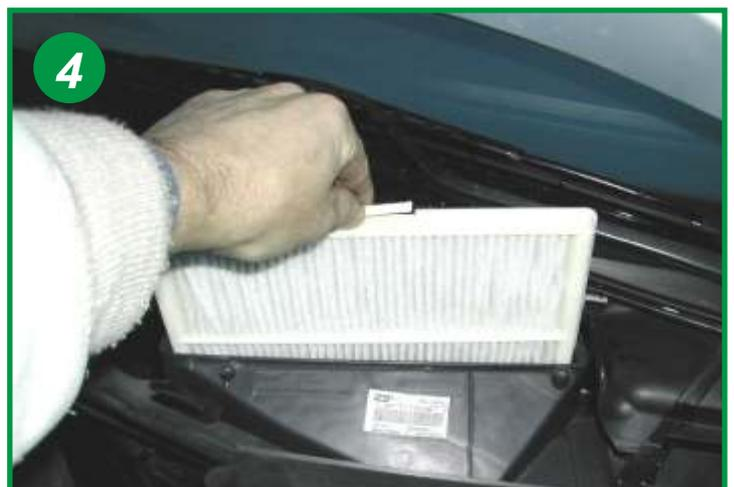
Extraire l'élément filtrant usagé en le tirant vers soi. Engager le nouvel élément dans les glissières. Le remontage s'effectue dans l'ordre inverse du démontage.
