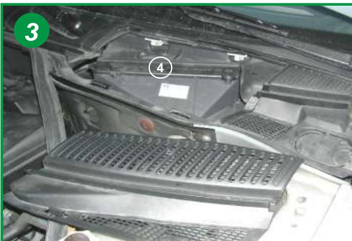
Retirer le couvercle du climatiseur maintenue par 2 vis (4).
