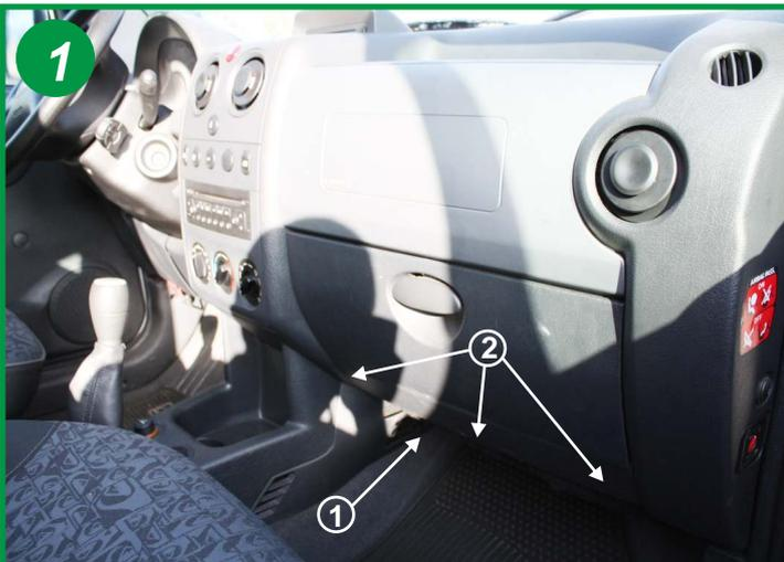
L'élément filtrant est situé dans l'habitacle du véhicule coté passager sous la boîte à gants (1).
