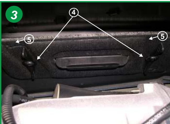
Dessous se trouve une trappe derrière laquelle est positionnée l'élément filtrant. Basculer les deux écrous papillons (4) vers la gauche d'environ 3 cm (voir flèches 5) et retirer cette trappe.
