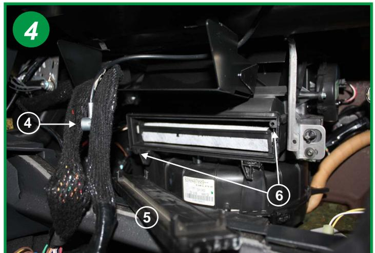
Ouvrir le couvercle du boîtier filtrant (5) à l'aide d'un tournevis ou dans certains cas en dévissant les 2 vis de 6 (6). Extraire le filtre usagé. Le remontage s'effectue dans l'ordre inverse du démontage.
