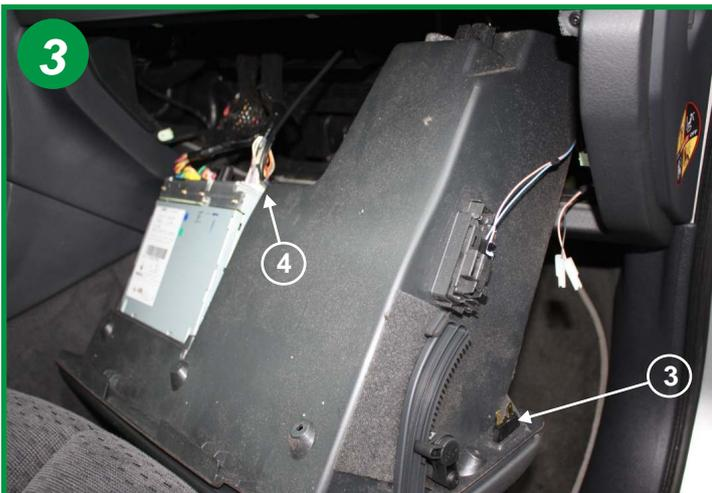
Sortir la boîte à gants après avoir débranché les deux cosses électriques (3) et la prise d'antenne de l'auto radio (4). Descendre au maximum le bloc complet.
