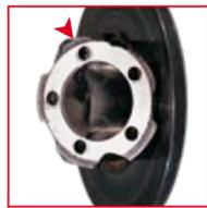
**AUSSEHEN** Nabenkontaktfläche gelöst oder verformt
