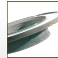
**AUSSEHEN** Übermäßiger Verschleiß. Die Dicke der Bremsscheibe liegt unter der vom Hersteller empfohlenen Mindestdicke
