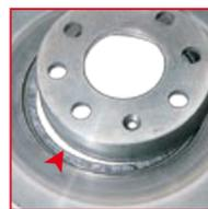
**AUSSEHEN** Ablösen des Bremsscheibentopfs von der Bremsfläche
