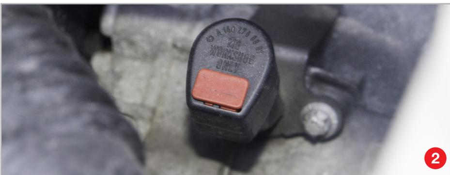
Die Verschlusskappe des Einfüllrohrs
