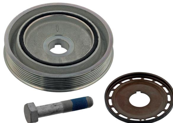
Die hier dargestellte Riemenscheibe treibt den Keilriemen der Nebenaggregate an. Sie besteht aus einem Gummi/Metall-Verbund. Die Verbindung zwischen dem Gummikern und den beiden Metallhälften löst sich mit der Zeit. Das verursacht ein Klappergeräusch, hauptsächlich bei Lastwechseln.
