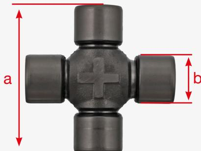
**DE** In Online-Teilesuchen sind einem Fahrzeugtyp häufig mehrere Kreuzgelenke zugeordnet. Wir empfehlen, vor der Teilebestellung das alte Kreuzgelenk mit den von uns hinterlegten Maßen abzugleichen. Dabei sollte die Länge des Kreuzgelenkes mit leicht angepressten Lagern (a) sowie der Außendurchmesser eines der vier Lager (b) gemessen werden.
