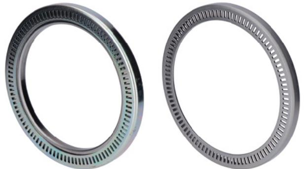
Bild 1: Der original eingebaute Kassettenwellendichtring (links) darf nicht mehr verwendet werden. Statt dessen muss der bei der Repair Insert Unit (RIU) mitgelieferte ABS-Ring (rechts) eingebaut werden.
