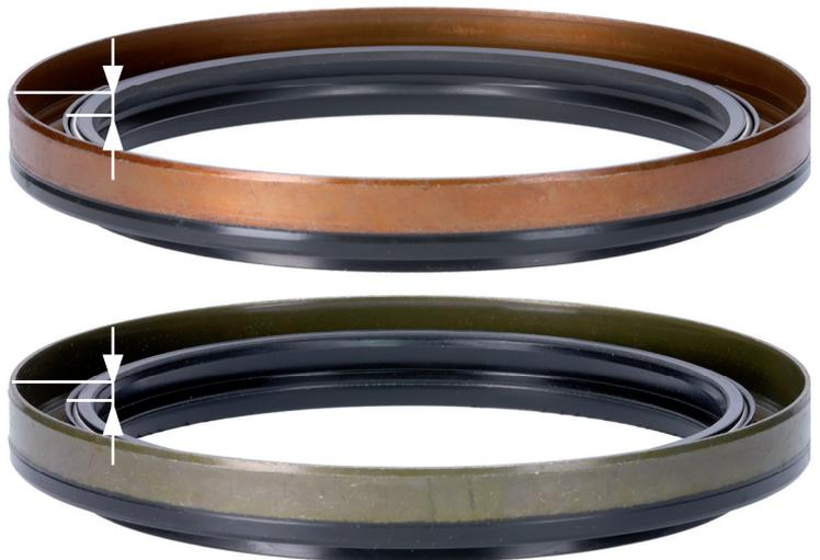
Bild 2: Die Dichtlippe des mitgelieferten Wellendichtrings (oben) unterscheidet sich nur geringfügig zur original eingebauten Ausführung (unten)
