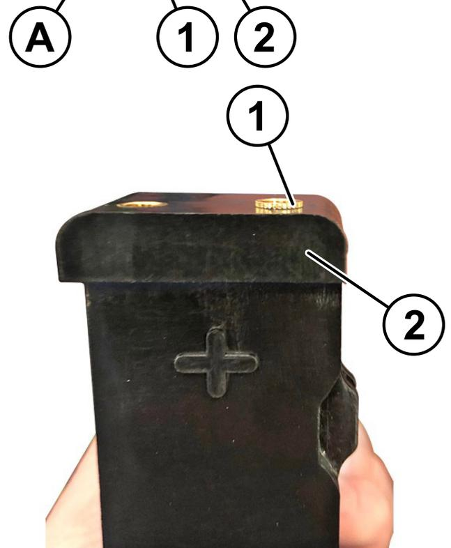
Spannung der neu einzubauenden Komponenten Batteriezellenblöcke (HV-Batterie) prüfen:
