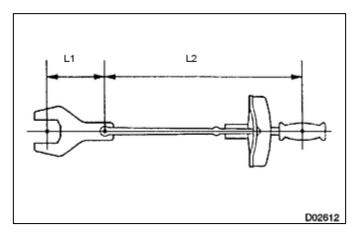
i. Mit Hilfe der nachstehenden Formel die Sonder-Drehmomentwerte für Anwendungsfälle berechnen, bei welchen ein SST oder eine Verlängerung zusammen mit einem Drehmomentschlüssel zum Einsatz kommt.
