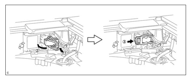
b. Den Griff des Wartungssteckers um 90° zur Batterie drehen und in Pfeilrichtung schieben, bis einklickendes Geräusch zu hören ist.
