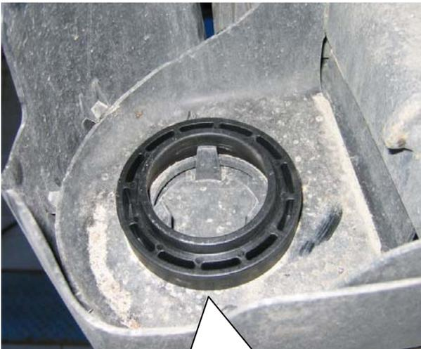
Der Spring Distance Kit wird unten zwischen Federunterlage **und** Achse montiert.
