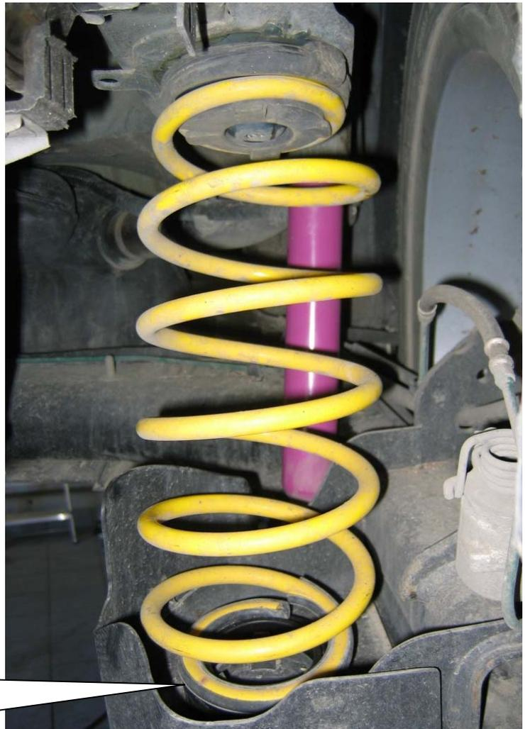
Am unteren Ende der Feder wird die Original Federunterlage weiterverwendet.
