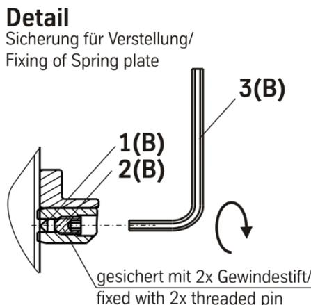
Den Federteller mit der/den im Bilstein Lieferumfang enthaltenen Gummikugeln/Klemmstiften (1), Gewindestift (2) und dem Hilfswerkzeug (Innen-6kt-Schlüssel (3)) sichern.
