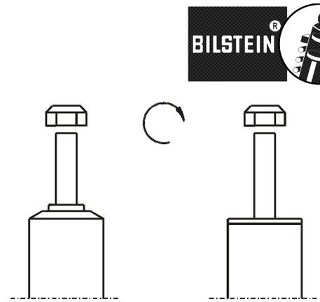
Um eine mögliche Zerstörung des Produktes zu vermeiden, darf zum Lösen und Anziehen der Muttern kein Schlagschraubendreher verwendet werden.
