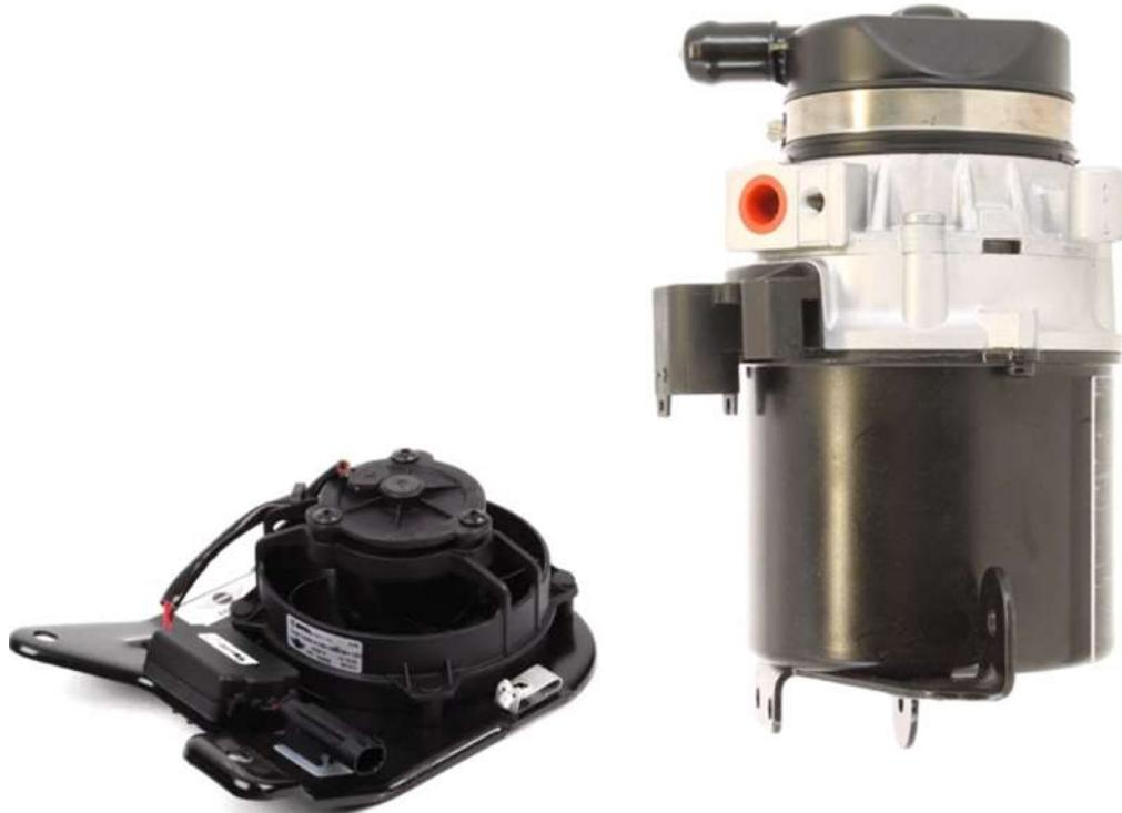
**La pompe 141463 est refroidie sur le véhicule par un ventilateur BMW 32 41 6 857 718. Il est important de vérifier son fonctionnement avant de changer la pompe. Toute défaillance de celui-ci peut conduire à une surchauffe et entraîner un refus de garantie de la pompe.**
