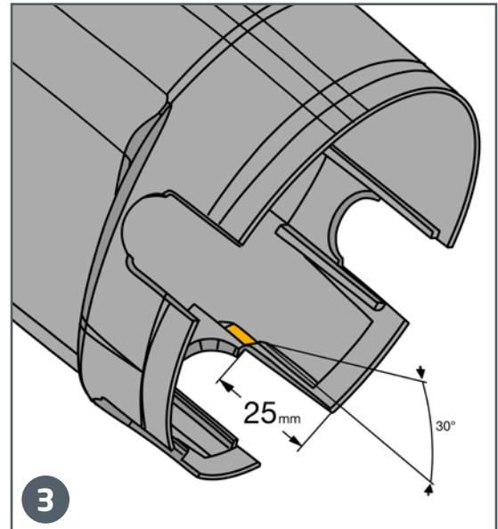
**on de commutation neutre.** Sur les véhicules fabriqués avant septembre 2003, vous devrez recouper la fente de guidage marquée en jaune sur le boîtier en plastique (cf. Illustration 3). Il s'agit d'une modification apportée par le constructeur.
