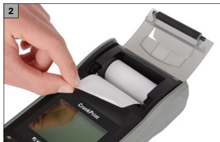
Fig. 2 Installation du rouleau de papier
