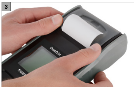
Fig. 3 Fermeture du couvercle du compartiment à papier
