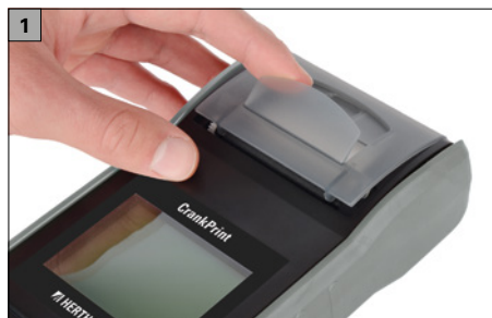
Fig. 1 Ouverture du couvercle du compartiment à papier
