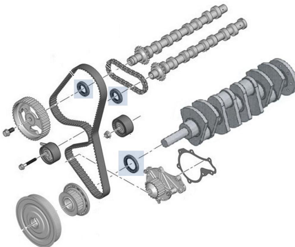
La **sustitución de los elementos de distribución** como correas, tensores, rodillo inversor y, en su caso, bomba de refrigerante, es un **mantenimiento imprescindible** que debemos realizar al vehículo según los intervalos aconsejados por su taller de confianza.
