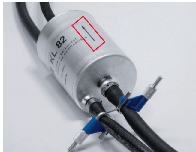
Илл. 2: Зажимы предотвращают вытекание топлива из шлангов подачи топлива
