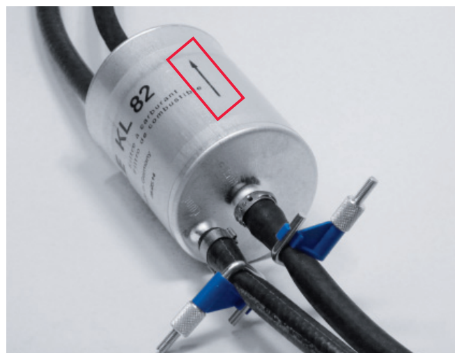
Ilustracja 2: Zaciskanie, aby zapobiec opróżnieniu przewodów paliwowych
