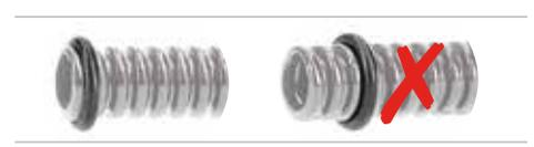
3. Setzen Sie als nächstes den Clip, der für den eigentlichen Wellrohrverbinder (Adapter für den Glattschlauch) gedacht ist, in die Rille hinter dem Dichtring ein und legen Sie es um das Wellrohr. Schieben Sie das Wellrohr in den Verbinder bis er einrastet. **Vorsicht!** Lässt sich das Rohr zu leicht oder zu schwer in den Verbinder einführen, wurde der falsche Dichtring verwendet.
