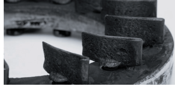
VTG: Yoğun kurum birikintisi mekanizmayı bloke ediyor
