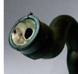
Yağ karteri havalandırması: Yoğunlaşma ve motor yağından oluşan bir çözeltiyle bloke olmuş
