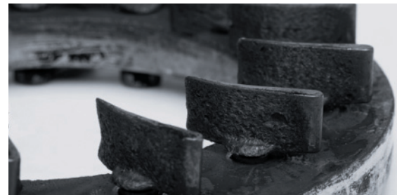
Geometría variable de la turbina: la fuerte sedimentación de carbonilla bloquea el mecanismo
