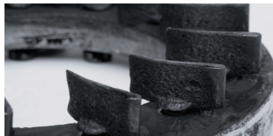
Система изменения геометрии турбины: вращение лопаток заблокировано из-за сильных отложений масляного нагара
