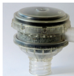
Система вентиляции картера с сепаратором масляного тумана
