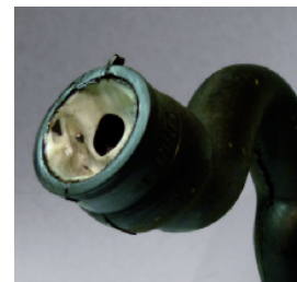
Kurbelgehäuseentlüftung: blockiert durch Emulsion aus Kondensat und Motoröl
