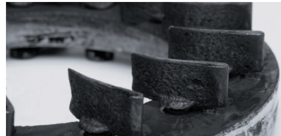
VTG: Starke Ölkohleablagerungen blockieren die Mechanik
