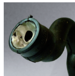
Odpowietrznik skrzyni korbowej – zatkany przez emulsję ze skroplin i oleju silnikowego
