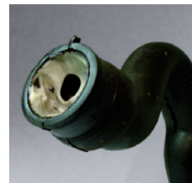
Ventilation du carter de vilebrequin bloquée par l'émulsion formée par les condensats et l'huile moteur
