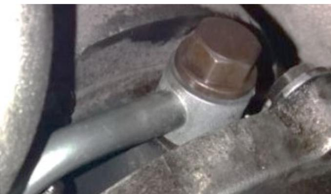
*En éste punto del montaje es donde reside la **importancia de la zona flexible del tubo**, dado que de ser totalmente rígido no sería posible su instalación.*
