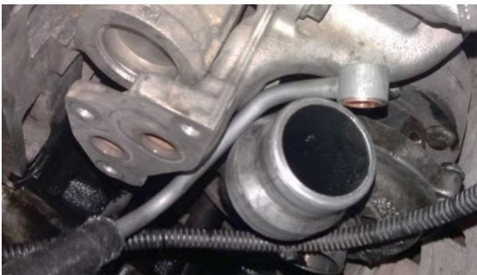
**7)** Para introducir el extremo del tubo en la culata es necesario tirar de la parte flexible del tubo en la dirección indicada. Después, roscar y aplicar el apriete correspondiente de 35 Nm.
