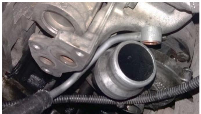
**6)** Colocar el tubo en su posición correspondiente en la zona del turbo y roscar el tornillo ligeramente sin llegar a apretarlo. En éste paso hay que asegurarse de que las arandelas de cobre queden correctamente posicionadas.
